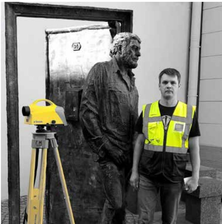
Измерение осадок геометрическим нивелированием II класса.
